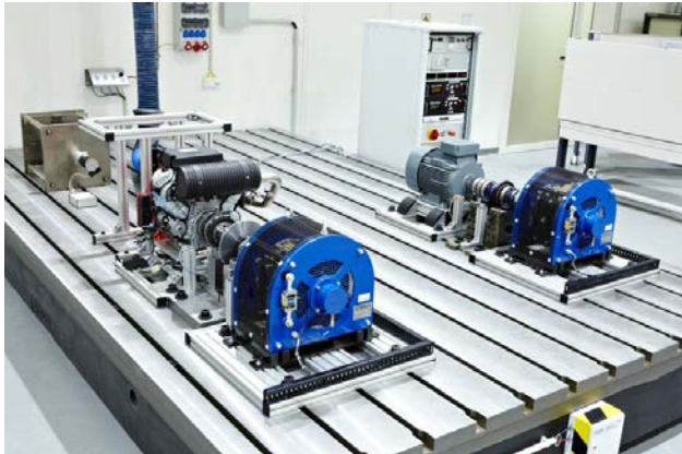
Drehschwingungsprüfstand zur Überprüfung des Simulationsansatzes.
